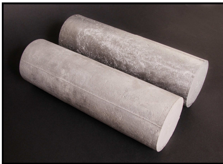
Obr. č. 4: Odlitky z Al-Si slitiny (1- před a 2 - po tepelném zpracování) [fotografie autora]
