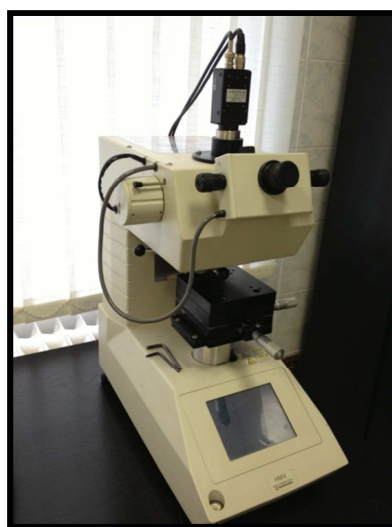
Obr. č. I: Shimadzu HMV Micro Hardness Tester
