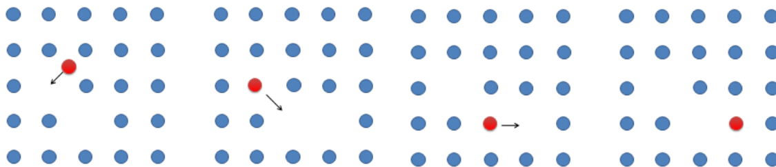
Obr. 26 Vakantní mechanismus difuze
