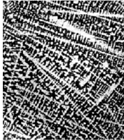
Obr. 15 Dendritická struktura oceli [5]
