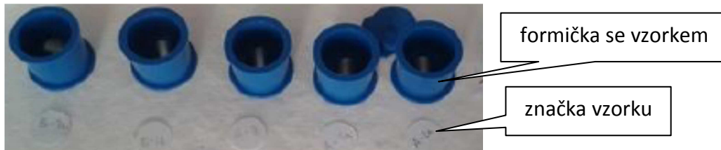
Obr. 35 Formičky se vzorky před zalitím pryskyřicí
