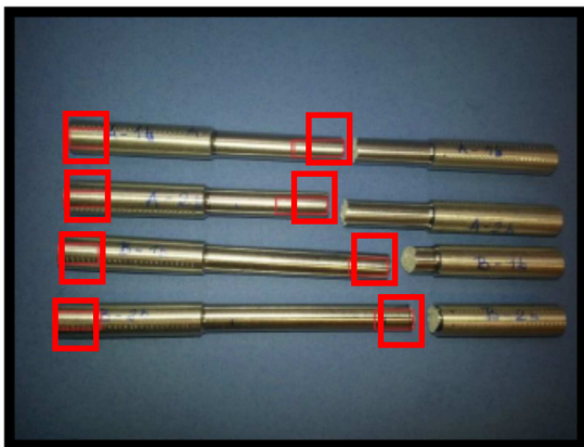
Obr. 32 Označení místa odběru vzorků
